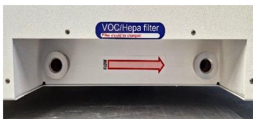
Rysunek 12.1 Strzałka kierunku przepływu na wielokomorowym inkubatorze do IVF MIRI® TL6 i MIRI® TL12
