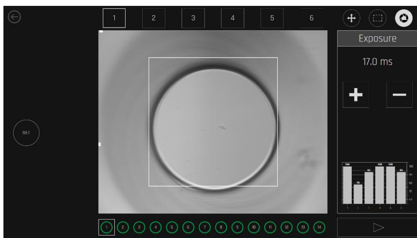
Rysunek 20.38 Widok ekranu regulacji czasu ekspozycji
