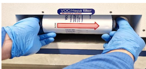
Rysunek 12.2 Procedura montażu i demontażu filtra LZO/HEPA
