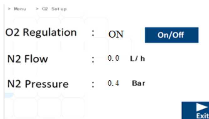
Rysunek 16.4 Widok podmenu „Ustawienia N 2 ” wielokomorowych inkubatorów do IVF MIRI® TL6 oraz MIRI® TL12
