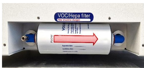
Rysunek 12.3 Prawidłowo zamontowany filtr LZO/HEPA
