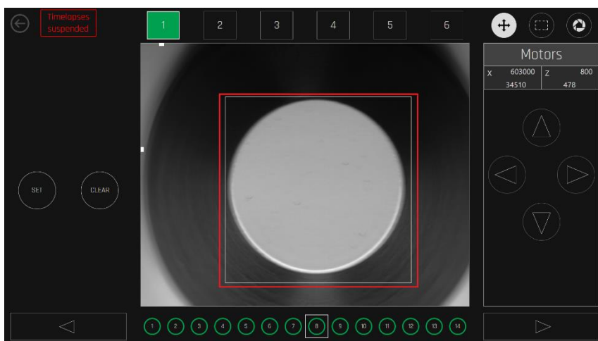
Rysunek 20.39 Prawidłowo wyregulowany widok dołka szalki
